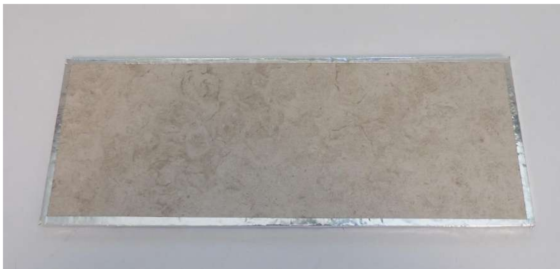
Eprouvette d'essai - Carreau céramique GDM44001 MADRAS GRIS
